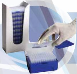
Nehmen Sie das erste Gitter von den Nachfüllspitzen ab und setzen Sie es in das Rack ein. Die Racks können wiederverwendet werden.
