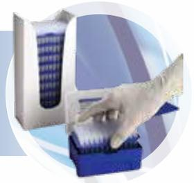
Bereiten Sie ein leeres Rack vor. Entfernen Sie das ursprüngliche Gitter.
