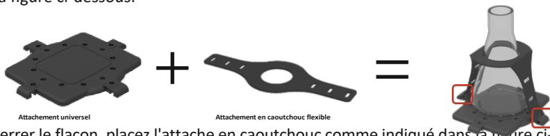
Pour serrer le flacon, placez l'attache en caoutchouc comme indiqué dans la figure ci-dessus et verrouillez-la avec l'attache universelle en étirant le caoutchouc.
