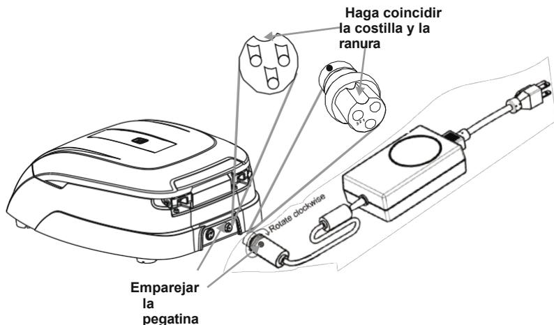
Después de conectar el adaptador de alimentación, encienda la fuente de alimentación principal y el interruptor en la trasera de la centrifuga. Asegúrese de comprobar el ajuste del rotor antes de su uso. La centrifugadora no funcionará con la tapa abierta.
