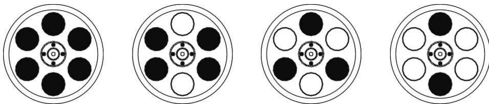
2. Este es el método para cargar los tubos simétricamente en el rotor. El punto más importante que hay que recordar es que las muestras en los tubos deben tener el mismo volumen.
