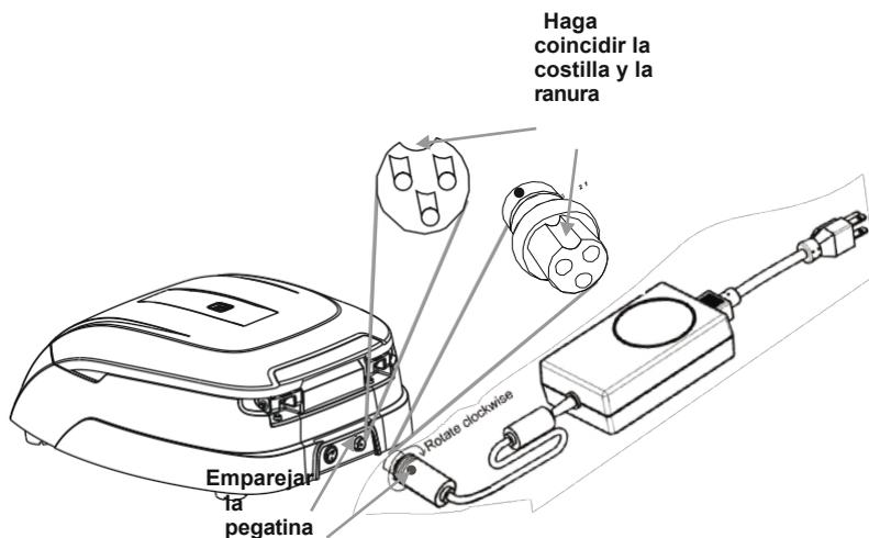
4. Si el ajuste es correcto, el tapón entrará fácilmente sin mucha fuerza (no intente forzar el tapón si no está correctamente ajustado). Una vez introducido el tapón en su posición, gire el anillo superior suelto en el sentido de las agujas del reloj para apretarlo y asegurar el ajuste.
