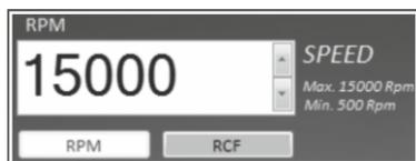
Questo riquadro "VELOCITÀ SU/GIÙ" viene utilizzato per leggere il valore della velocità delle linee attive del programma. Ad esempio, se è in esecuzione la riga 3 del 46° programma, la casella "VELOCITÀ SU/GIÙ" visualizzerà il valore della velocità della riga 3 del 46° programma. Può
