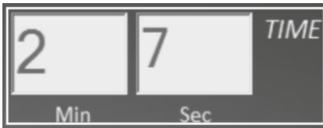
Il riquadro "TESTO TEMPO" viene utilizzato per leggere il valore del tempo rimanente delle righe attive del programma. Ad esempio, se la riga 3 del 46° programma è in esecuzione, la casella "TESTO TEMPO" visualizzerà il valore del tempo rimanente della riga 3 del 46° programma. Si tratta di un timer per il conto alla rovescia.
