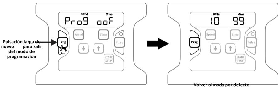
**NOTA:** En cada reinicio, el aparato sale automáticamente del modo de programación. Muestra el último valor predeterminado de velocidad y tiempo de ejecución.
