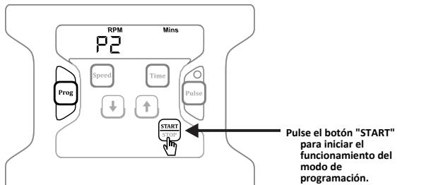
Para detener el funcionamiento, pulse "Stop".
