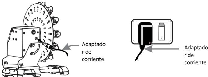
Después de conectar el adaptador de corriente a la parte posterior del aparato, ponga la fuente de alimentación principal en "ON" y, a continuación, encienda el aparato por la parte posterior. Asegúrese de que los tubos están correctamente cargados antes de usarlos.
