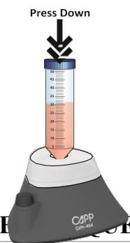
Le mélangeur s'arrête lorsque l'éprouvette est retirée. Dans le mini-mélangeur vortex variable, tourner le bouton de vitesse pour augmenter ou diminuer la vitesse entre 2000 et 4500 tours/minute. Tournez dans le sens des aiguilles d'une montre pour augmenter la vitesse et dans le sens inverse pour la diminuer.
