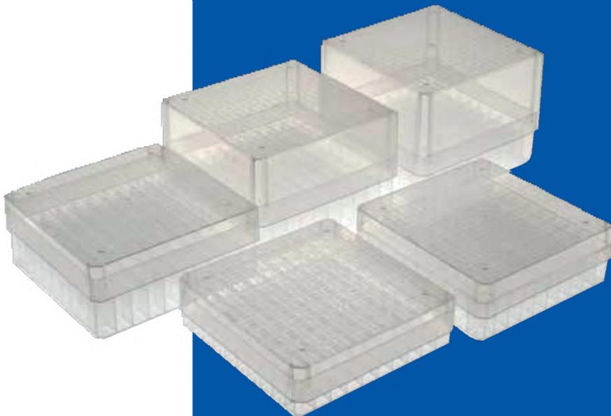
Die EXPell Cryo Boxen von CAPP sind aus hochfestem Polypropylen gefertigt und eignen sich sowohl für das Einfrieren bei  $-90^{\circ}\text{C}$  als auch für das Einfrieren bei  $-90^{\circ}\text{C}$ . Autoklavieren bei  $+121^{\circ}\text{C}$  für 20 Minuten.
