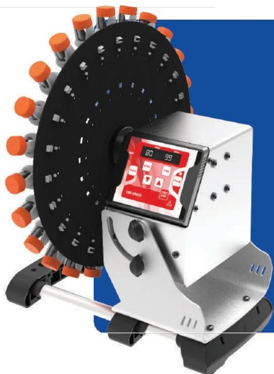
performances optimales, en s'appuyant sur des recherches approfondies et sur les précieux commentaires des utilisateurs. Équipé d'un moteur BLDC sans entretien, ce rotateur offre un fonctionnement silencieux, efficace et fiable.
