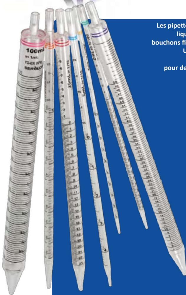
Les pipettes sérologiques CAPPHarmonie assurent une manipulation précise des liquides grâce à des graduations précises, des têtes à code couleur et des bouchons filtrants pour un travail sans contamination. Fabriquées en polystyrène USP CLASS VI, elles sont durables, polyvalentes et compatibles avec de nombreuses applications. Parfaites pour des résultats fiables dans n'importe quelle configuration de laboratoire.
