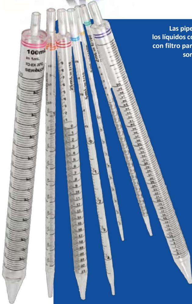
Las pipetas serológicas CAPPArmonía garantizan una manipulación precisa de los líquidos con graduaciones exactas, cabezales codificados por colores y tapones con filtro para trabajar sin contaminación. Fabricadas en poliestireno USP CLASE VI, son duraderas, versátiles y compatibles con varios pipeteadores. Perfecto para obtener resultados fiables en cualquier .
